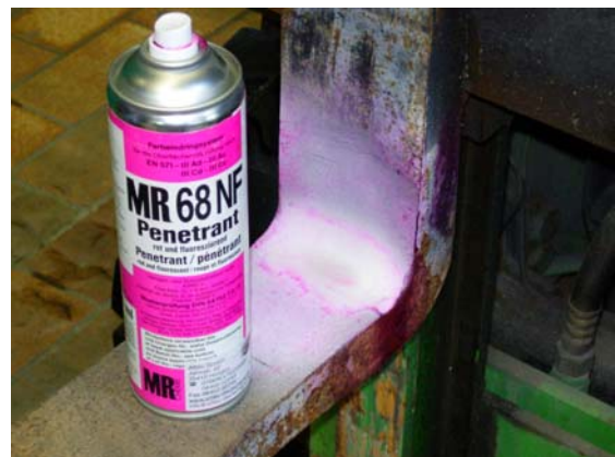
Staplergabel nach Prüfung mit MR-Rißprüfset
