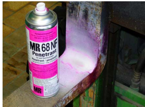
Staplergabel nach Prüfung mit MR-Rißprüfset
