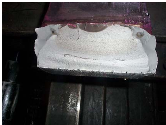
Gebrochene Staplergabel Der Haarriss wurde durch unzureichende Prüfung nicht erkannt, was letztlich zum Bruch führte.
